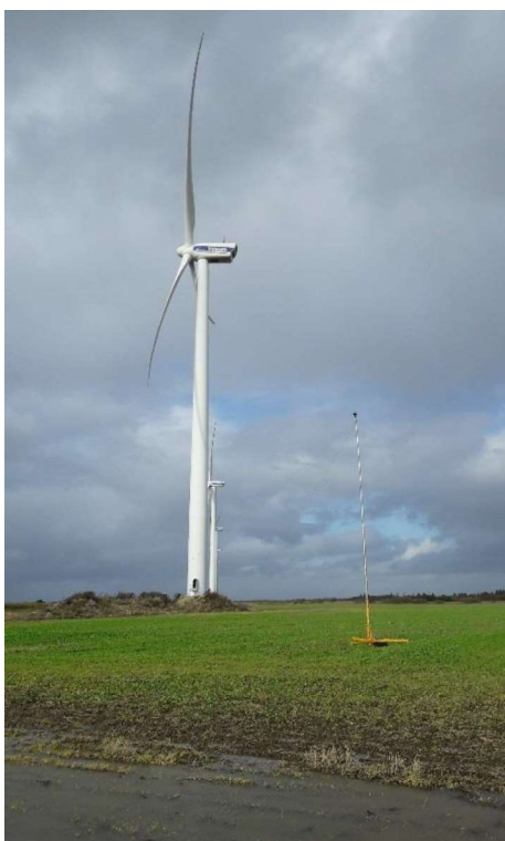
Figur 7. Foto af anemometer placering ved vindmølle 5, måleserie 3.
